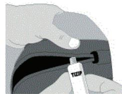
Im späteren Gebrauch sollte der TIZIP Easy gelegentlich nachgefettet werden (ungefähr nach jedem 10. Gebrauch). Eine kleine Tube Gleitfett mit Anwendungshinweis liegt jedem Reißverschluss bei. Etwas Gleitmittel auf den äußeren Flanken des Dichtprofils reduziert die Betätigungskräfte erheblich.
